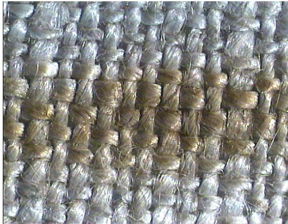
Due dei lini usati ingranditi: i fili della trama sono 0.3-0.4 mm in diametro. I lini B (a sinistra) e F (a destra) sono stati irraggiati con il laser a 308 nm, 100 colpi con 16.1 MW/cm<sup>2</sup>/colpo a 9 Hz. La colorazione marrone scuro non è del tutto omogenea a causa di un fascio laser non uniforme.
